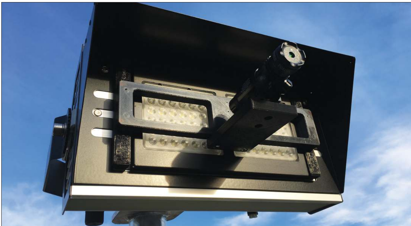
Ovan: Inriktning Modus med hjälp av laser
